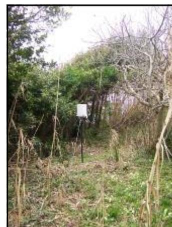
② Pluviomètre installé par le BRGM sur la propriété « la muserie »
