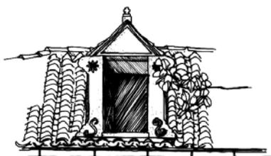
Constituées de tuiles de terre cuite. La tuile mécanique dite « de Marseille » (tuile plate à emboîtement) est employée, ainsi que la tuile canale. Selon la pente de toiture.
